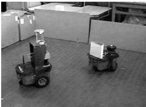
Figura 7: Experimentos: posicionamento do robô seguidor em relação ao mestre.
